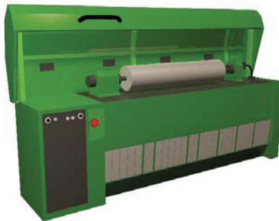
Slika 34. Šematski prikaz uređaja za oslikavanje digitalne flekso štamparske forme
